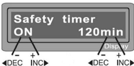
Данный экран отображает настройку отсечки по времени. По истечении заданного времени процесс зарядки/разрядки будет остановлен. Таймер можно выставлять в пределах от 0 до 720 мин. Таймер также можно отключить, в этом случае процесс заряда/разряда будет бесконтрольным по времени.
