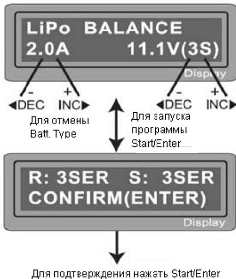
На этом экране слева сверху отображается тип заряжаемой батареи, ниже - текущий ток заряда. После установки параметров тока и напряжения, нажмите кнопку “**START/ENTER**” и удерживайте её нажатой в течение 3-х секунд, до тех пор, пока не прозвучит мелодия. (Для отмены и возврата в пред идущее меню нажмите “**Batt. Type/Stop**”)
