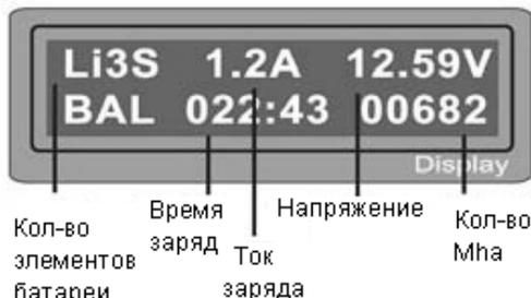
Если процесс заряда начался, то будет отображаться экран процесса заряда в реальном времени. Процесс заряда всегда можно прервать вручную, нажав на кнопку “**STOP**”.
