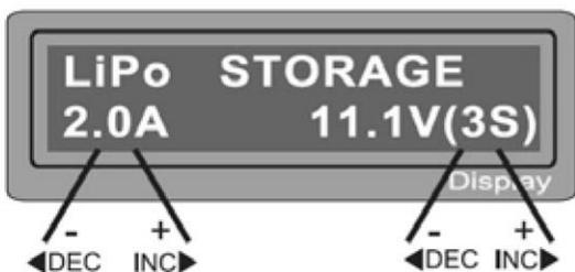
На этом экране слева сверху отображается тип заряжаемой батареи, ниже - текущий ток заряда. После установки параметров тока и напряжения, нажмите кнопку “**START/ENTER**“ и удерживайте её нажатой в течение 3-х секунд, до тех пор, пока не прозвучит мелодия. (Для отмены и возврата в предыдущее меню нажмите “**Batt. Type/Stop**”)
