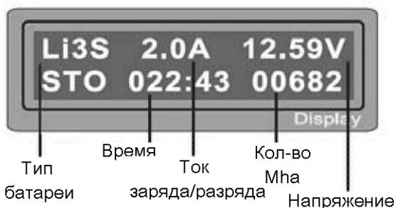
Если процесс заряда начался, то будет отображаться экран процесса заряда в реальном времени. Процесс заряда всегда можно прервать вручную, нажав на кнопку “**STOP**“.
