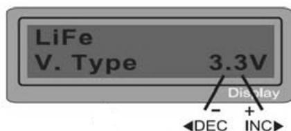
Данный экран отображает номинальное напряжение для литиевой батареи. ЗУ работает с тремя типами батарей и для каждого типа используется своё напряжение:
