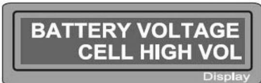
Напряжение одного из элементов батареи слишком высокое. Пожалуйста, проверьте каждый элемент по отдельности.
