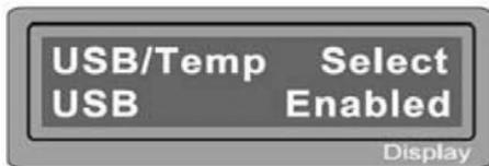
Если параметр установлен как USB порт, Вы можете подсоединить ЗУ к вашему ПК через дополнительный кабель USB, чтобы контролировать процесс заряда на экране монитора.
