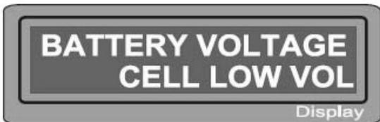
Напряжение одного из элементов батареи слишком низкое. Пожалуйста, проверьте каждый элемент по отдельности.
