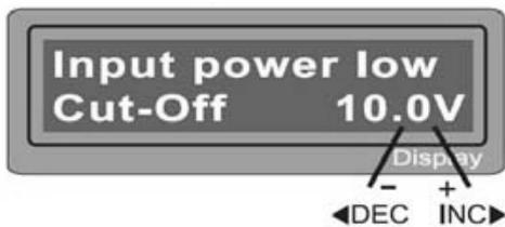
Здесь можно выставить отсечку по входному напряжению (в пределах 10 – 11 Вольт), это позволит избежать глубокого разряда автомобильной батареи при работе зарядного устройства.
