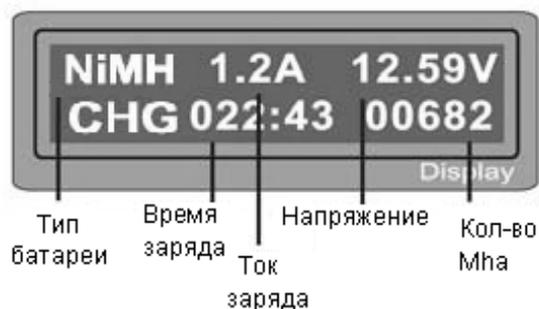
На экране отображен статус заряда в реальном времени. В любой момент можно прервать процесс заряда, нажав на кнопку “STOP”. При окончании процесса заряда, зарядное устройство оповестит звуковыми сигналами и соответствующей информацией на экране.
