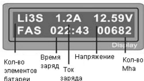
Если процесс заряда начался, то будет отображаться экран процесса заряда в реальном времени. Процесс заряда всегда можно прервать вручную, нажав на кнопку “**STOP**“.
