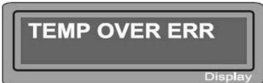
Внутренняя температура зарядного устройства слишком высокая. Пожалуйста, дайте остыть зарядному устройству.
