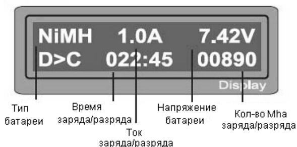
После окончания всех операций заряда/разряда, ЗУ оповещает о завершении звуковыми сигналами. На экране можно увидеть результаты работы зарядного устройства: какая емкость была выдана аккумулятору и какая забрана. Нажатием "INC" и "DEC", можно посмотреть результат по каждому циклу.
