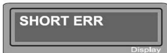
Короткое замыкание на выходных клеммах
