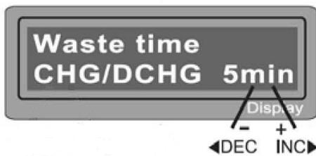
Данный экран отображает настройку времени охлаждения. Батарея нагревается в процессе разряда/заряда, поэтому необходимо давать ей время остыть. Программа ставит временную задержку после каждого цикла заряда/разряда, чтобы позволить остыть батарее, перед тем как начнется следующий цикл. Параметр может принимать значение от 1 до 60 мин.
