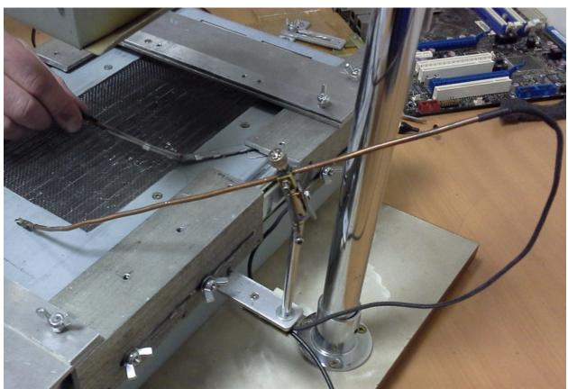
«Шея» журавля сделана из медной трубки диаметром 3мм, которую при необходимости можно легко согнуть руками как угодно для обхода неудобно расположенных деталей на плате, вылет регулируется винтовым зажимом. Прижимная пружина закреплена так, что в рабочем положении прижимает датчик к плате, и в то же время удерживает «журавля» в верхнем положении, когда нужно, без всяких дополнительных фиксаторов, чисто за счет кинематики.
