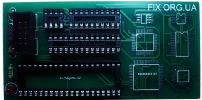
Прошивать им просто: поставил драйвера, вставил МК в нужный слот, выбрал программатор из списка (COM выбирать не нужно), указал микроконтроллер и его частоту и лей программу.
